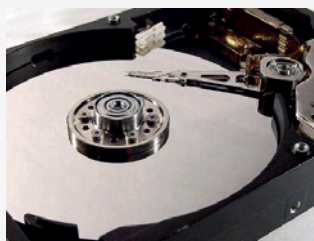
Wnętrze dysku twardego z widocznym talerzem
